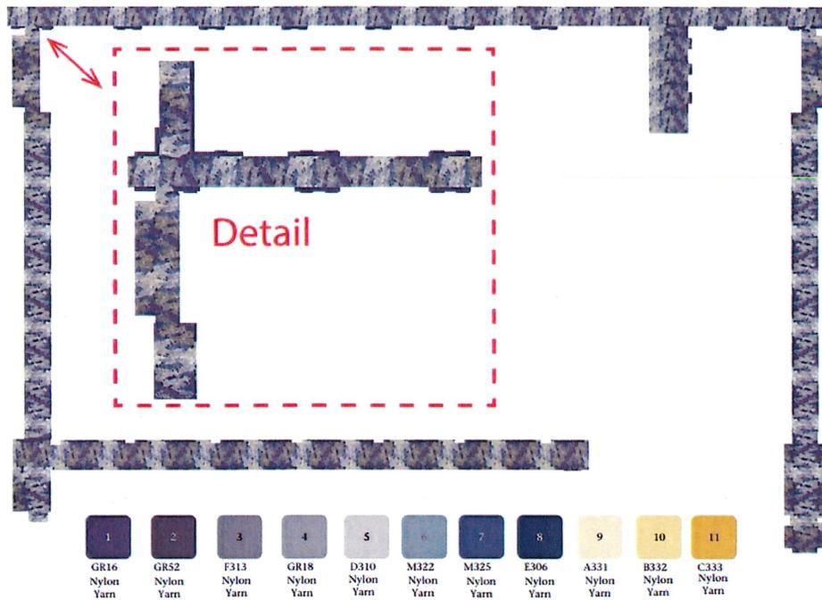
4.2.1 จะต้องเป็นพรหมทอเครื่องเอ็กซ์มินสเตอร์ (Axminster) ชนิดขนตัด ความหนาขนพรหม (Pile height) อย่างน้อย 6.4 มิลลิเมตร
